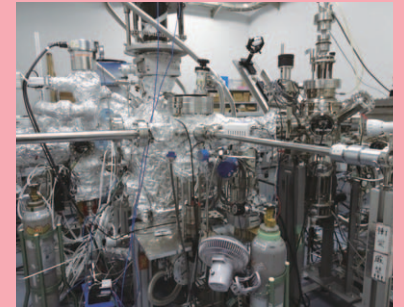
原子レベルで薄膜堆積可能で物質の電子状態がわかる一体型超高真空装置
