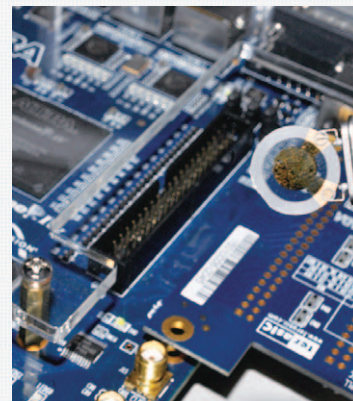
水晶振動子ガスセンサと制御回路
