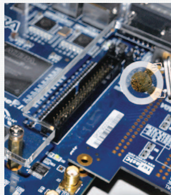
水晶振動子ガスセンサと制御回路
