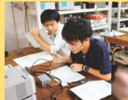
③実技試験:測定結果からブラックボックス内の回路を論理的に明らかにする試験
