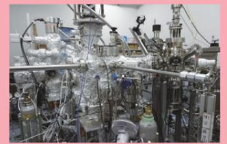
原子レベルで薄膜堆積可能で物質の電子状態がわかる一体型超高真空装置
