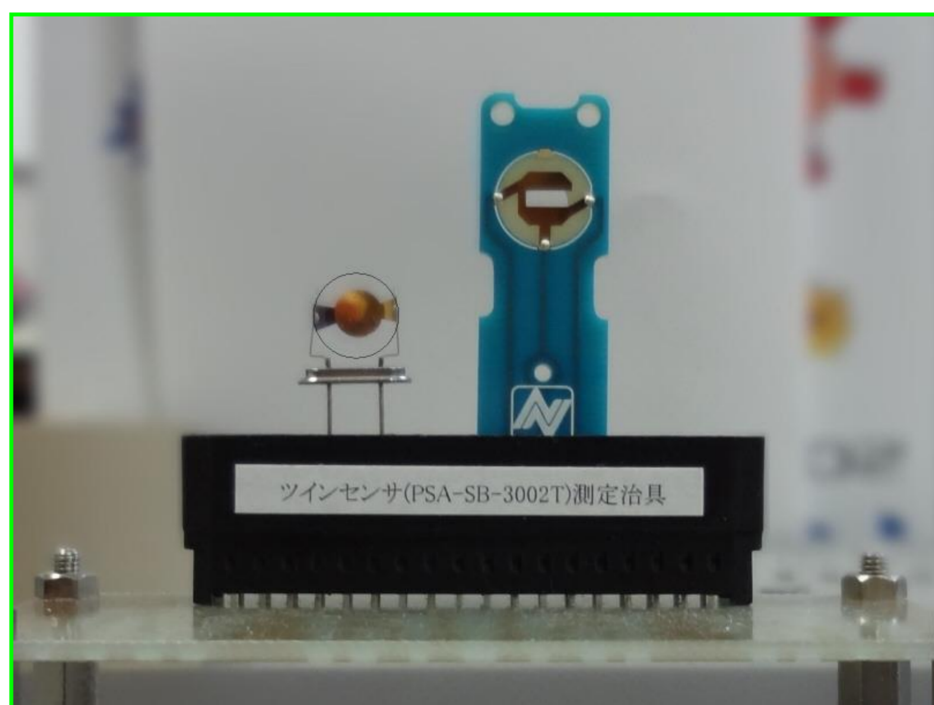
ノイズキャンセリング機能を持ったガスセンサ
